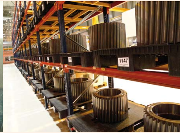
Vasemmalla oleva raaka-aihiö muuttuu valmiiksi planeettahammaspyöräksi monen toimenpiteen kautta. Keskellä suoritetaan suuren tarkkuuden hiontaa. Oikealla olevat hammaspyörät ovat valmiita kokoonpanoon.
