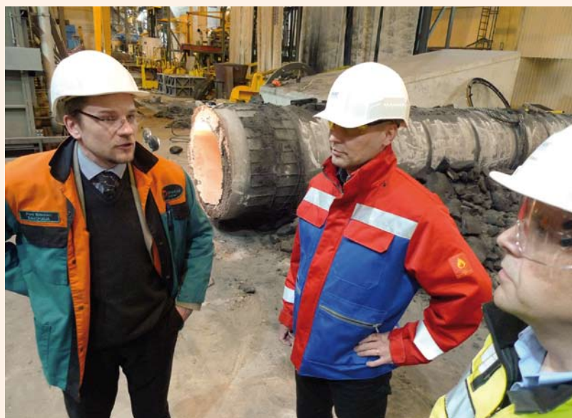
Juuri valettu tela purkuvaiheessaan, vielä hiukan ympäröimänä. Telan paino on 40 000 kg, pituus 11 m ja halkaisija 1,1 m. Puhdistuksen, sahauksen ja jälkikäsitteilyn jälkeen se menee samalla tontilla toimivaan Metson yksikköön koneistettavaksi. Noin neljän kuukauden kuluttua se on valmis paperikoneen soft-kalanteri.
