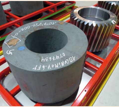
Vasemmalla oleva raaka-aihiö muuttuu valmiiksi planeettahammaspyöräksi monen toimenpiteen kautta. Keskellä suoritetaan suuren tarkkuuden hiontaa. Oikealla olevat hammaspyörät ovat valmiita kokoonpanoon.
