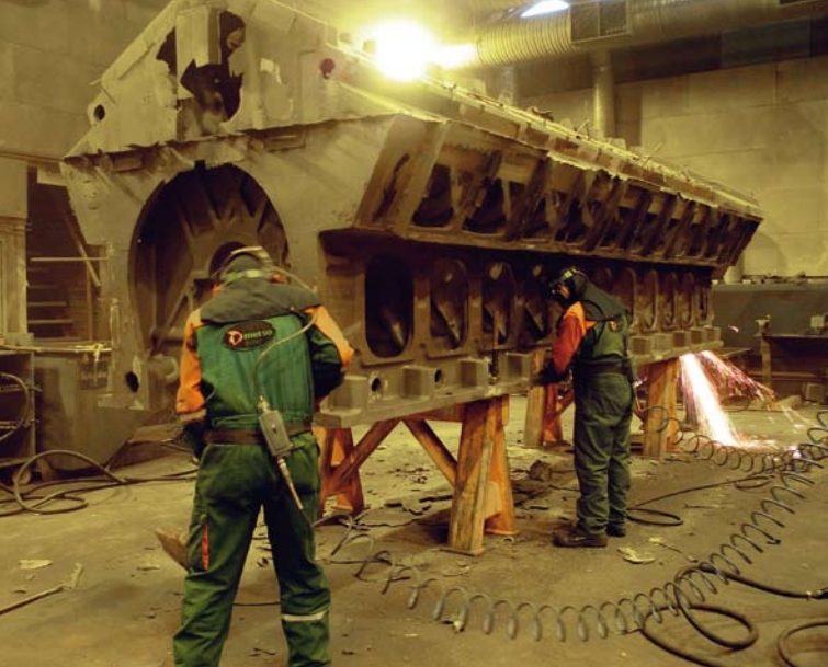
Wärtsilän 18 sylinterisen v-moottorin elämä alkaa tästä. Kuvassa tehdään viimeistelyä, jonka jälkeen lohko matkaa koneistukseen. Joskus valmis moottori pyörittää voimalaitosta tai kuljettaa laivaa. Suurin Jyväskylässä valettava moottorilohko painaa 30 000 kg.
