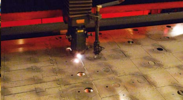
Laserleikkuria käytetään lukuisten erilaisten ohutlevy-kappaleiden valmistukseen. Sen kapasiteettia myydään myös ulos ulkopuolisten tarpeisiin.
