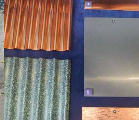
Kuparista muokkaamalla ja pinnoittamalla jalostettuja julkisivulevyjä.
