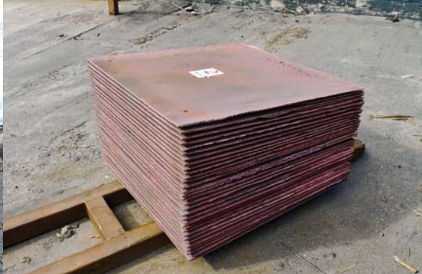
Porin Boliden Harjavalta Oy:n tuote on anodilevystä 99,995 % kupariksi elektrolyyttisesti puhdistettu, metrin kanttiinsa oleva 100-kiloinen katodilevy.
