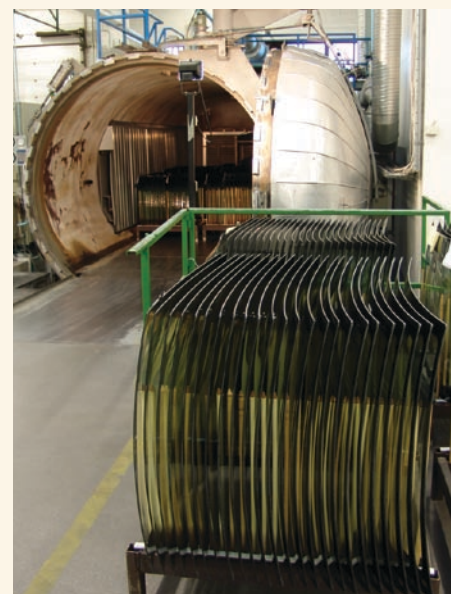
Tuulilaseja menossa kolmeksi tunniksi autoklaavin 10 barin ylipaineeseen ja 145 asteen lämpötilaan.
